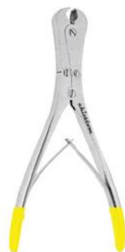
09-597 180 mm (7 1/8") kleszcze do cięcia drutu /Drahtschneidezangen/wire cutters Do drutów: miękki max. 2,0 mm twardy max. 1,5 mm /Für Draht: Weich max. 2,0 mm Hard max. 1,5 mm /For wires: Soft max. 2,0 mm Hard max. 1,5 mm
